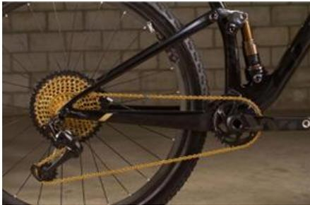
I **numeri dei denti** determinano quanta strada si fa con una pedalata. La circonferenza delle ruote è circa 2 m.
