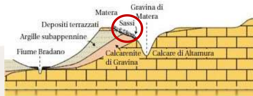
Calcarenite sulla quale sorgono i Sassi: morbida da scavare e impermeabile
